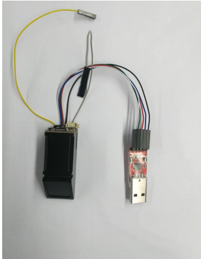
图 4-3 串口通信方式连接图
